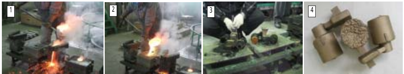
通常の鋳型と凍結鋳型の両方に注湯、鋳型をばらし比較検討している様子。凍結鋳型の特性、品質を実体験で理解することとなる。(株)光合金製作所と室蘭工業大学によるインターンシップの様子)
