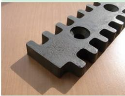
耐摩耗性金属の新開発の刃を使用することで、20日以上連続使用が可能になった、新品の耐摩耗性金属刃。
