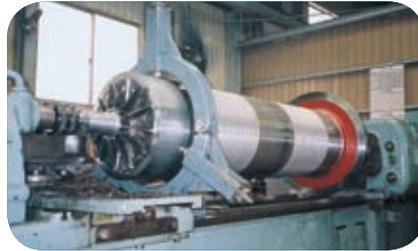
▲クレーン巻上げドラム機械加工
