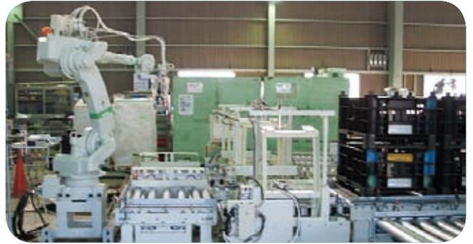
▲ロボットシステムによる自動ハンドリング装置
