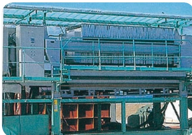
▲水処理装置（高圧薄層フィルタープレス）
