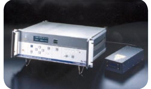
▲レーザードップラー速度（測長）計
