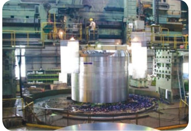
▲塔槽用圧力容器 (超大型 NC 立旋盤加工)
