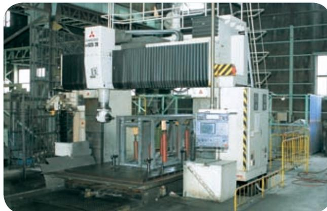
▲五面加工機による加工 (MVS25/20)
