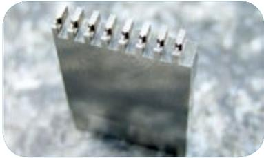
▲ EDM 加工（微細形状加工）
