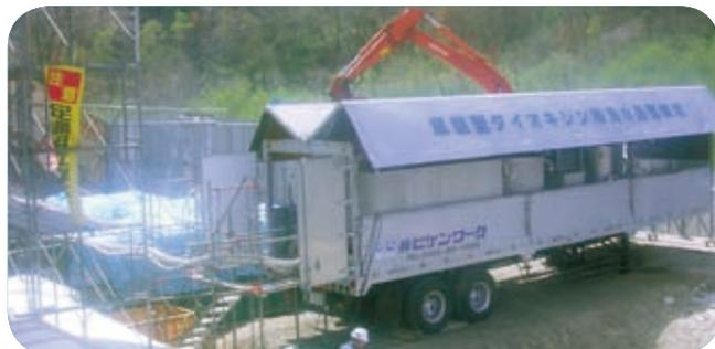
▲車載型ダイオキシン除染水処理装置
