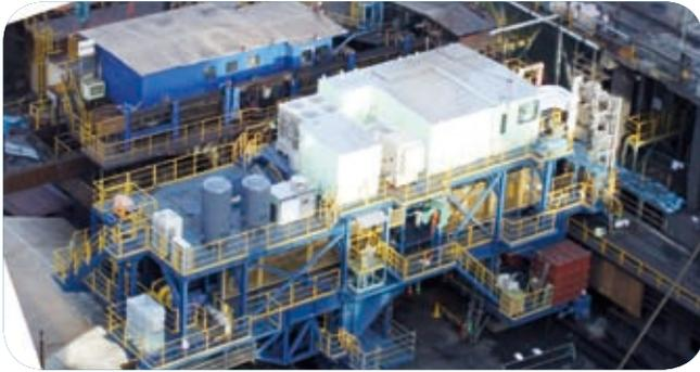
▲室蘭5コークス炉炭化室診断・補修装置
