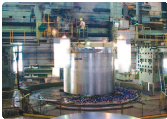
▲塔槽用圧力容器 (超大型 NC 立旋盤加工)
