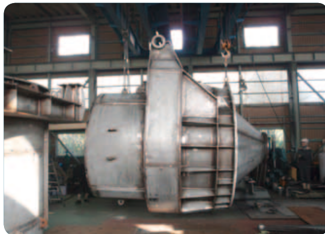
▲ニューマチックアンローダレシーバータンク部
