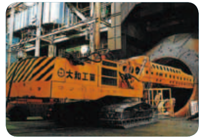
▲転炉及び鍋煉瓦解体機
