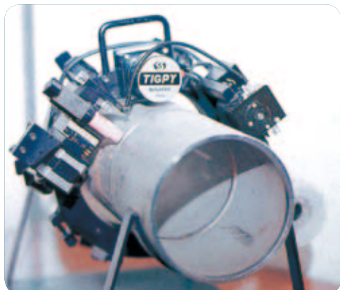
▲パイプ円周自動溶接装置
