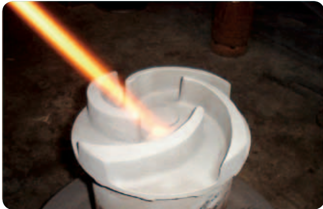
▲ポンプインペラー超高速フレーム溶射 (JP - 5000)
