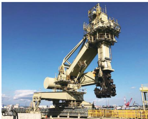
◀アンローダ（貨物船の船倉等から穀物、鉄鉱石をくみ上げる）
