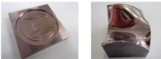
特別な技術を複数組み合わせる事により、数本の工具による短時間の切削で鏡面に近い加工を実現。曲面加工も可能に！
