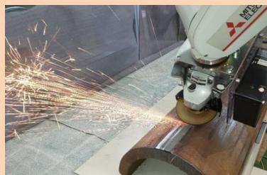
研削ロボットのシステム開発。
