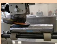
棒鋼キズ自動除去ロボットシステムの開発。
