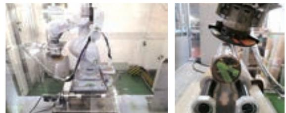
棒鋼キズの検出手法やキズ部研削形状の制御、棒鋼を回転させ全周研削を可能とするターニング装置などの開発を行い、手動と同等以上の加工精度を誇る棒鋼キズ自動除去ロボットシステムの開発に成功。
