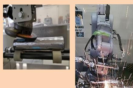
棒鋼のキズを自動除去するロボットシステムを開発。
