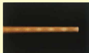
高速フレイム(HVOF)溶射
