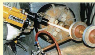
セラミック(ローカイド)溶射
