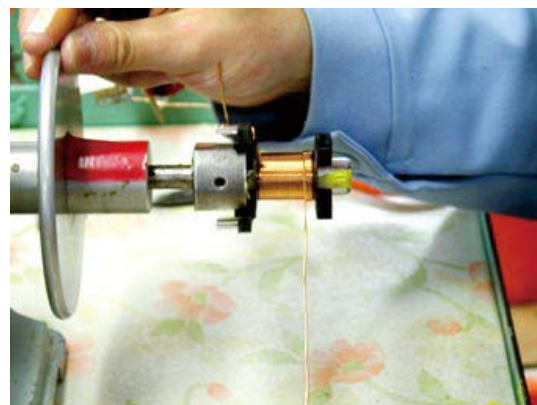
▲世界中で使われている手巻きコイル。 電気製品の種類や機能によって作り方が異なる。
