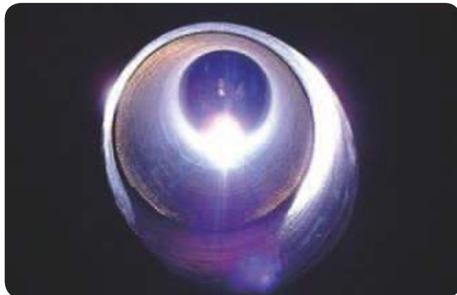
▲寿命を迎えたプランジャースリーブを特殊溶接で 新品同様に再生する「スリーブ内径溶接」のようす
