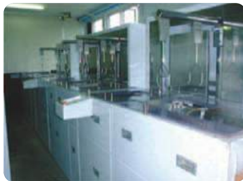
▲流水式純水洗浄機
