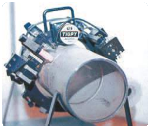
▲パイプ円周自動溶接装置
