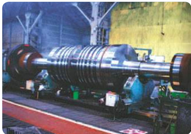
▲一体型 LP ロータシャフト (超大型 NC 旋盤加工)
