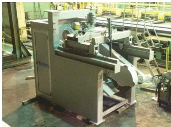
▲圧延鋼材傷取り研磨機制作
