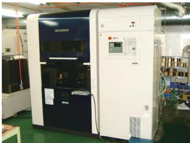
▲ワイヤー放電加工機 三菱電機PA05SM
