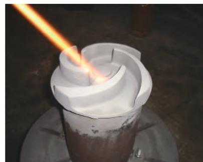
▲インペラー超高速フレイム溶射
