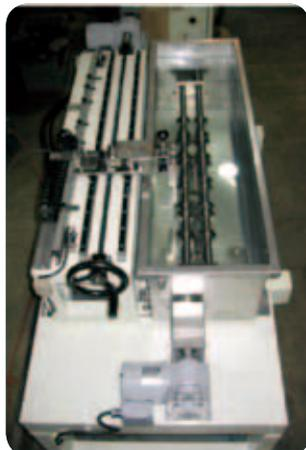
▲水槽型超音波探傷装置
