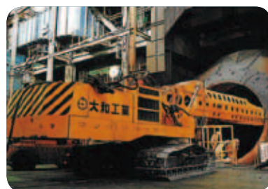
▲転炉及び鍋煉瓦解体機
