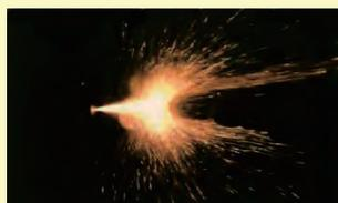
溶線式フレイム溶射(ワイヤー溶射)
