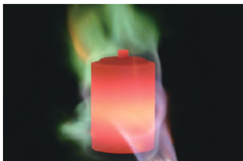
▲プランジャーチップ自溶性合金溶射 (熔融温度1100℃)
