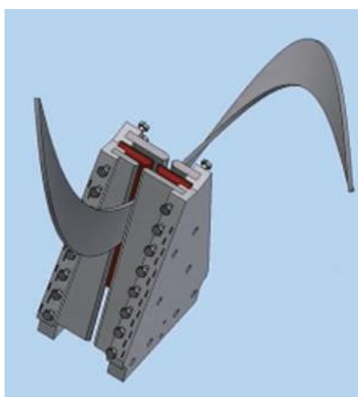
スクリー羽根フォーミングマシンと加工イメージ
