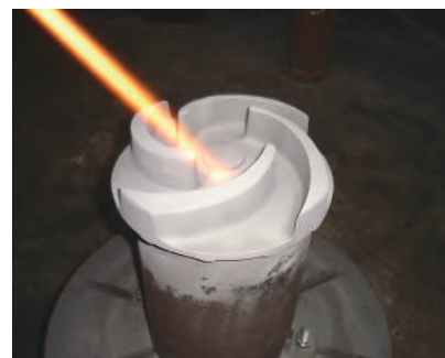
▲インペラー超高速フレイム溶射 (JP-5000)
