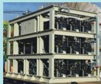
1,000Nm 3 級水素吸蔵合金タンク
