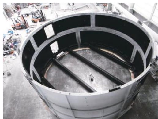
▲排ガス冷却塔 φ9000×10500H 製作中 パネル式現地組み立て型
