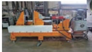
高い寸法精度が求められるスクリュー羽根を成型する専用機械及び金型の開発により、生産効率・品質・作業性等の大幅な改善を実現。
