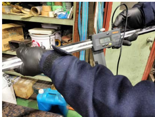
②導入後（手元スイッチ・フットスイッチで測定値記録可能）
